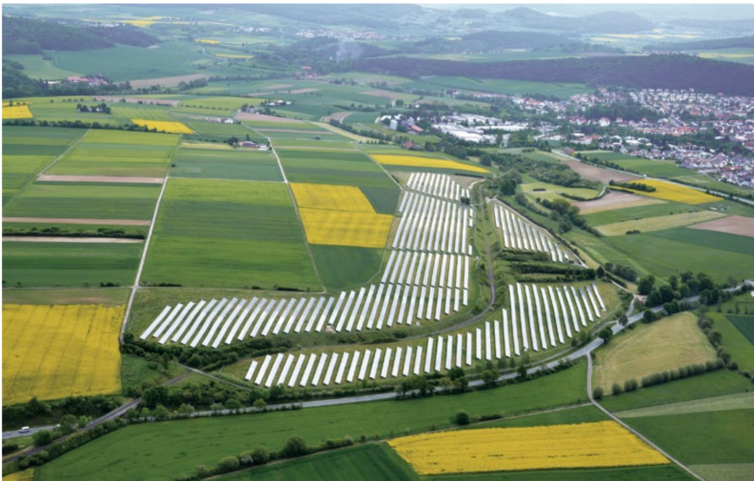
Solarpark Wolfhagen: 42.000 Solarmodule auf einer Fläche von 18 Hektar entlang der Bahnstrecke zwischen Wolfhagen und Gasterfeld liefern seit 2012 Sonnenstrom für rund 3.000 Haushalte.
